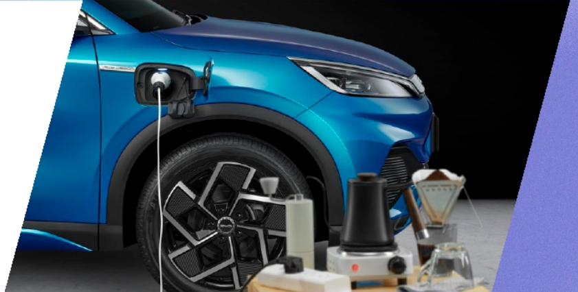
ฟังก์ชัน V2L (Vehicle to Load) สามารถต่อกระแสไฟ 220V จากรถยนต์ไปพ่วงใช้กับอุปกรณ์ไฟฟ้าอื่นๆ ได้
